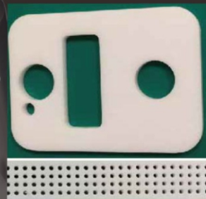
材質：二氧化鋁 孔徑：0.4mm, 深度：6mm
